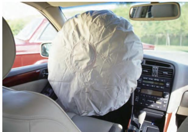
以约30km/h时速正面撞上不会被撞断的电线杆、撞进卡车等车底时,安全气囊都可能不启动。
